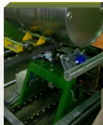
Posicionador ubicado antes de la estación de remachado.
