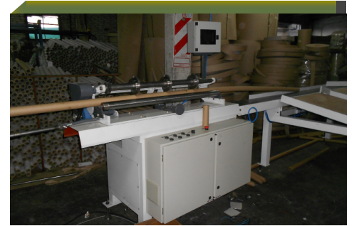
Máquina de corte múltiple desarrollada para Tubosur en producción.
