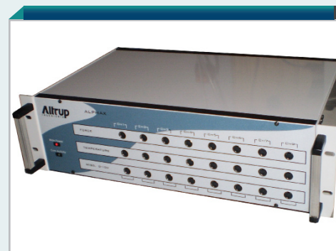
Sistema de adquisición de datos y visualización en tiempo real de 24 canales analógicos.
